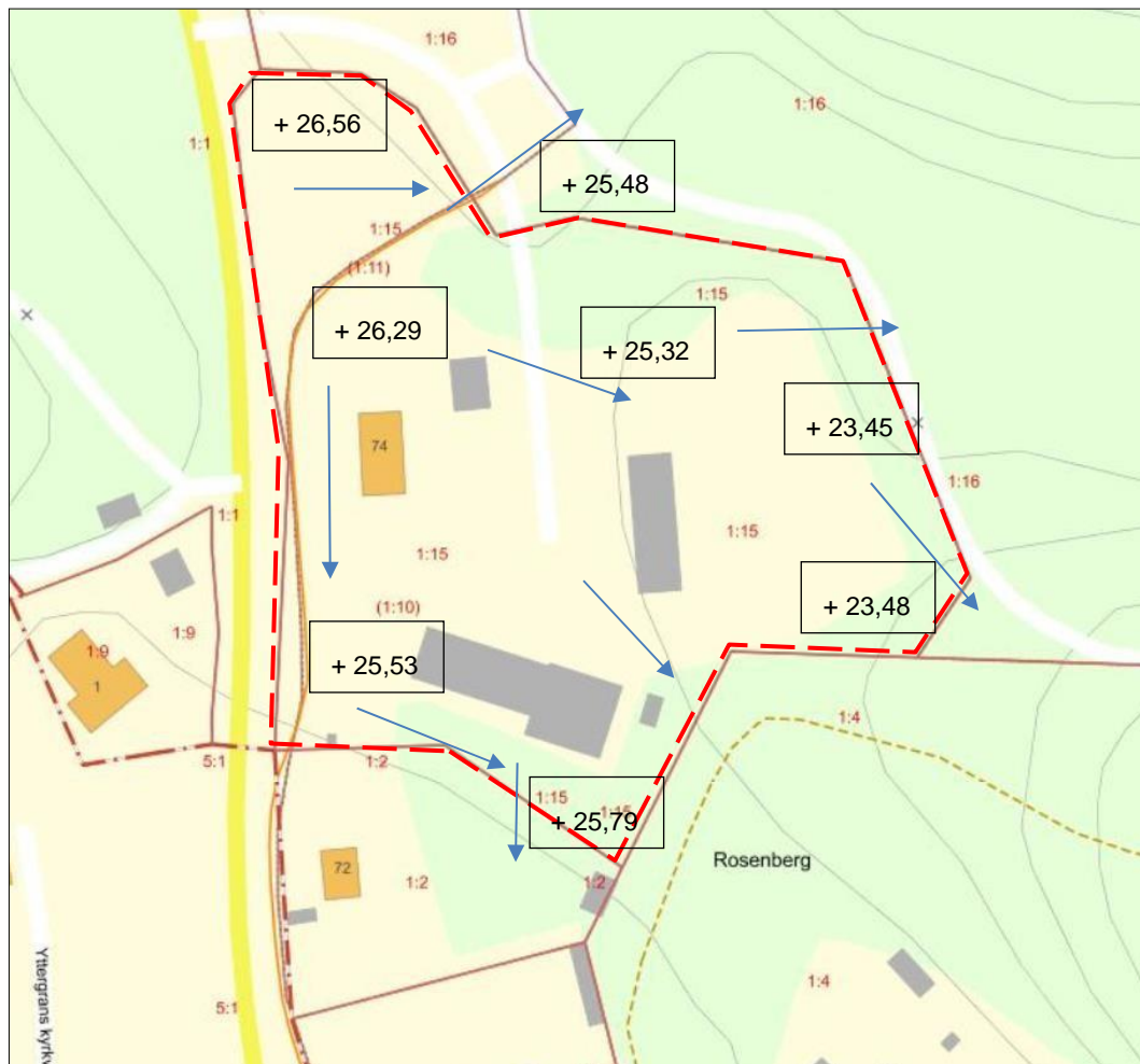
Figur 6. Ytlig avrinning inom och från planområdet idag sker till Lilla och Stora Ullfjärden. Blåa pilar anger vattnets riktning.
