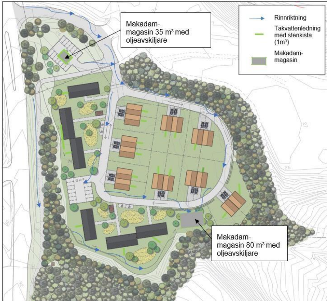
Figur 7. Föreslagen placering av makadammagasin för rening av dagvatten inom planområdet. Blå pilar visar ytvattnets rinnriktning.
